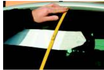
3. Schriftzug einmessen u. mit überstehender Übertragungsfolie fixieren
