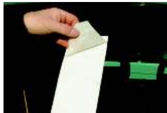
2. überstehende Übertragungsfolie von Rückseite lösen
