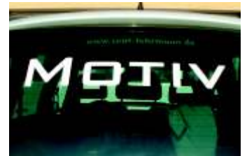
8. Prüfung der Kanten u. wenn nötig mit Heißluft nachwärmen
